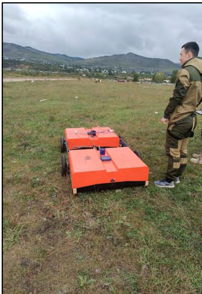
Рисунок 2.2 – Проведение георадиолокационных работ
