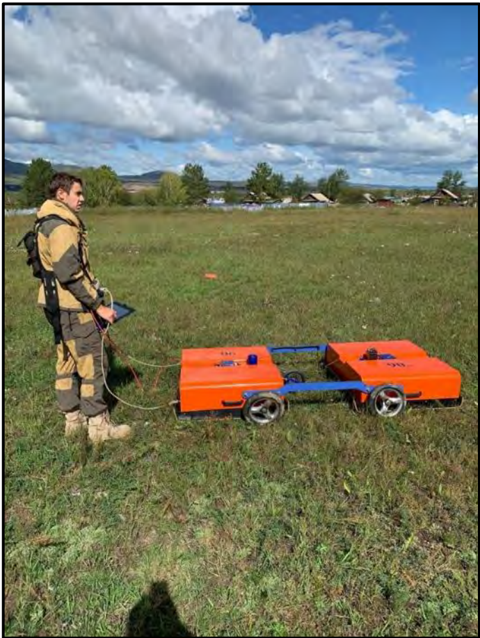
Рисунок 2.3 – Проведение георадиолокационных работ
