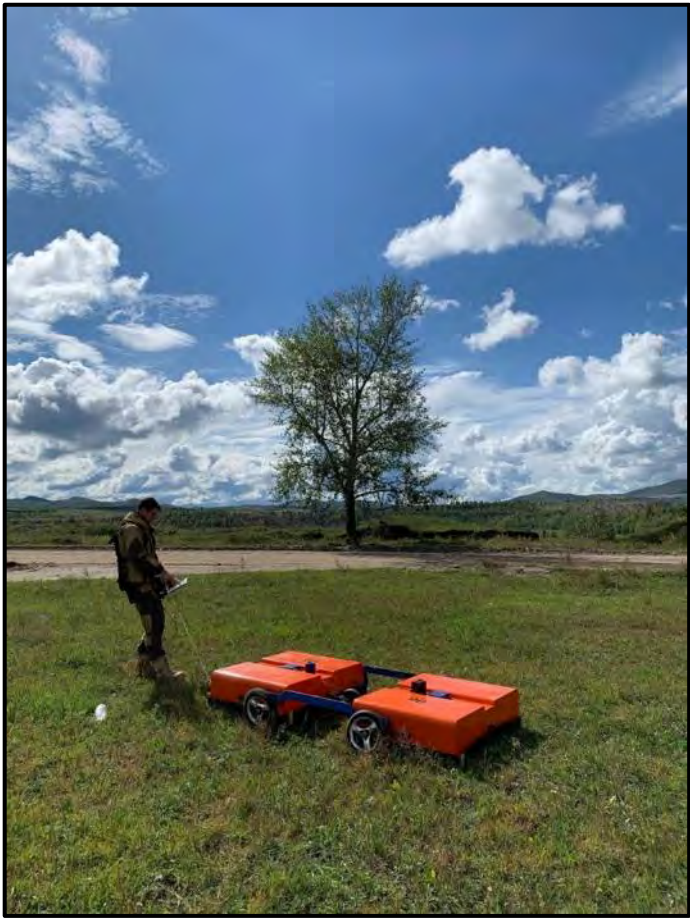
Рисунок 2.4 – Проведение георадиолокационных работ
